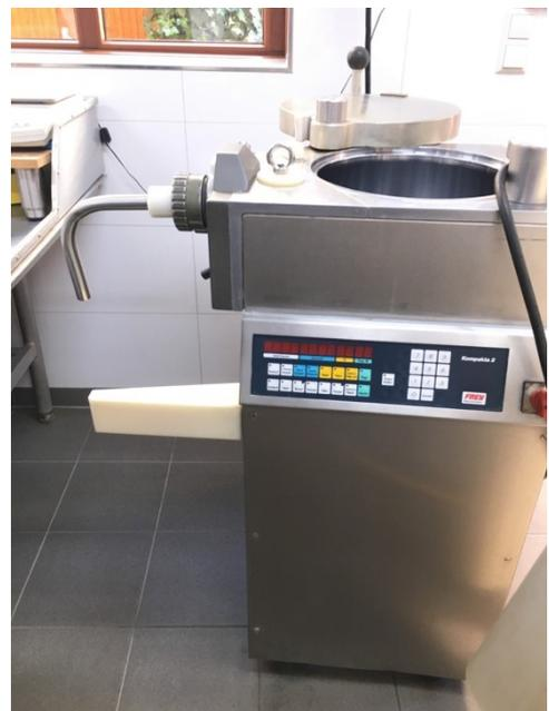
Diese Abfüllmaschine ist eigentlich für Wurstfabrikation gebaut worden, eignet sich aber gut um Senfgläser einzufüllen.
